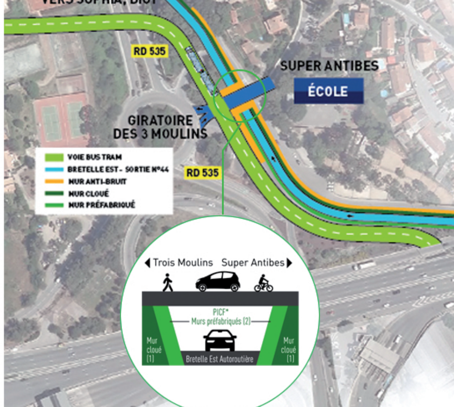
Les murs réalisés entre le giratoire des Trois Moulins et Super Antibes
