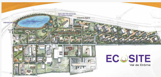
Ecosite : le site est aménagé dans une démarche environnementale : cheminements favorisant les déplacements doux, éclairage public innovant à taille humaine, gestion des eaux pluviales par phyto-épuration, chauffage collectif au bois alimentant les bâtiments et cahier des charges réglementant les constructions.
